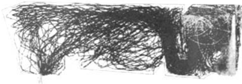
图 3 中间包内夹杂物运动迹线图 Fig.3 Moving trace of inclusions in tundish
